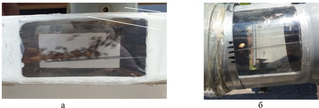
Рисунок 3 – Материалопровод пневмотранспортера с пассивным вибратором: а - прямоугольного сечения 108x50 мм; б – круглого сечения диаметром 110 мм
